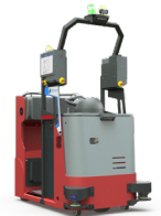
Tracteur robotisé hybride, jusqu'à 6 tonnes
