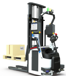
Gerbeur robotisé hybride, jusqu'à 2 tonnes
