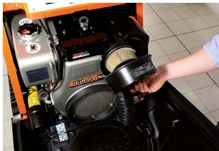
Une grande ouverture du capot donne accès aux principaux composants pour l'entretien quotidien: le réservoir à carburant, le filtre à air, la jauge d'huile moteur, la batterie et le coupe-circuit sont facilement accessibles.
