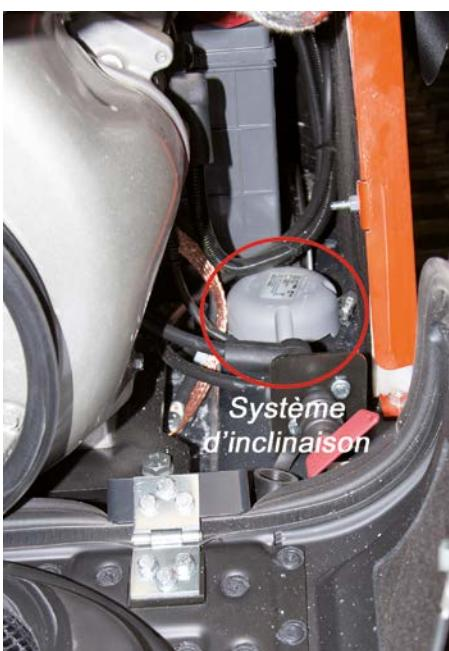
Une alarme retentit lorsque la benne est à une certaine hauteur si l'inclinaison est supérieure à 8°. Un capteur situé dans le compartiment moteur, détecte l'inclinaison du châssis. Un micro-interrupteur de montée de la benne, situé sur le mât, permet de détecter la position de la benne.
