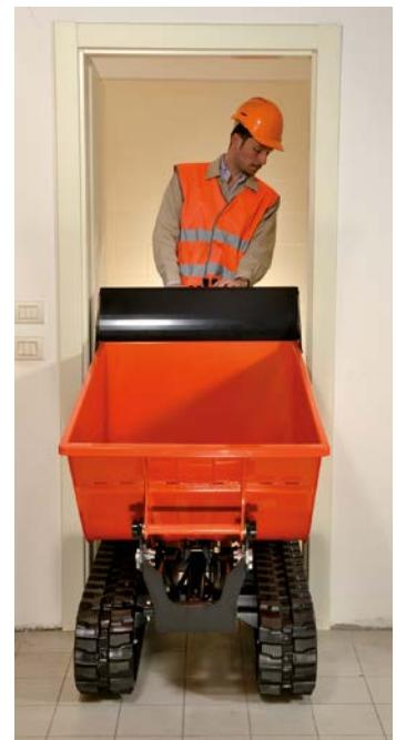
Avec une largeur totale minimum de 758 mm (pour toutes les versions) le KC70-4 transporte vos matériaux en passant facilement par les portes et portails, entre les maisons et les bâtiments, et dans les passages étroits. C'est le transporteur idéal pour les travaux de rénovation et les travaux urbains.
