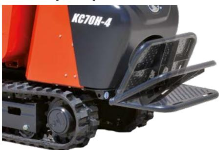
Le KC70-4 dispose d'un marchepied pliable. Quand il est déplié, l'opérateur peut s'y tenir debout en toute sécurité pour faire fonctionner la machine. Lorsque le marchepied est remonté, la longueur totale est réduite de 214 mm afin de gagner de l'espace pour le transport ou le stockage. La position debout permet à l'opérateur de monter et de descendre facilement de la machine.
