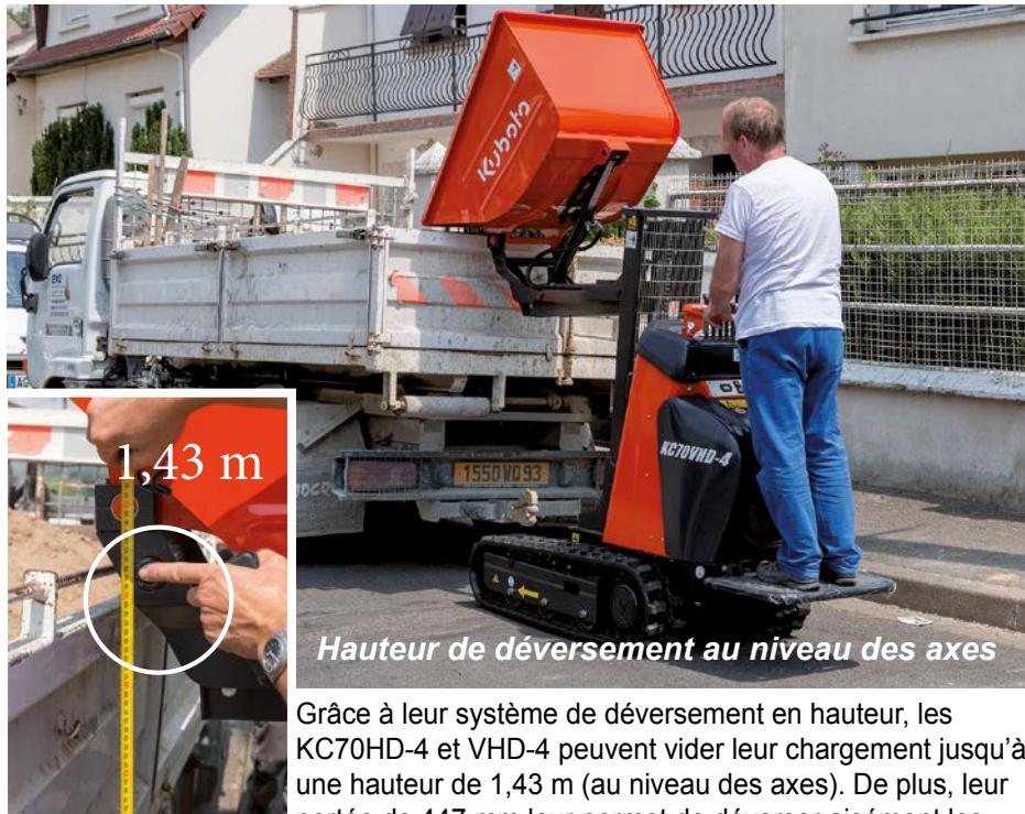
Grâce à leur système de déversement en hauteur, les KC70HD-4 et VHD-4 peuvent vider leur chargement jusqu'à une hauteur de 1,43 m (au niveau des axes). De plus, leur portée de 447 mm leur permet de déverser aisément les matériaux au delà du bord de la ridelle d'un camion.
