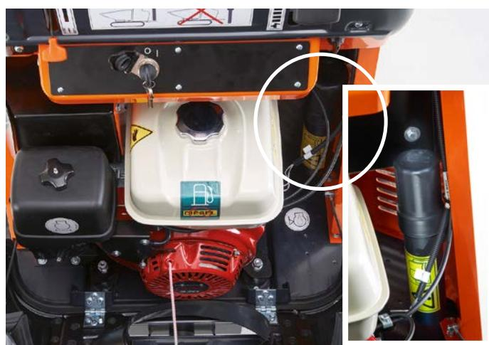
Une boîte à documents étanche protège les manuels d'utilisation dans le compartiment moteur verrouillé. Cela permet à l'opérateur d'avoir toujours les documents de la machine à portée de main.
