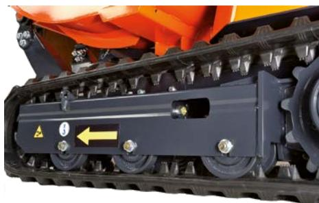
Les chenilles caoutchouc sont tendues par un vérin à graisse. Cette fonction permet aux chenilles de garder une certaine souplesse lorsque des matériaux s'insèrent au niveau de la chenille. En outre, le pas court de la chenille réduit les vibrations pour un meilleur confort de l'opérateur.
