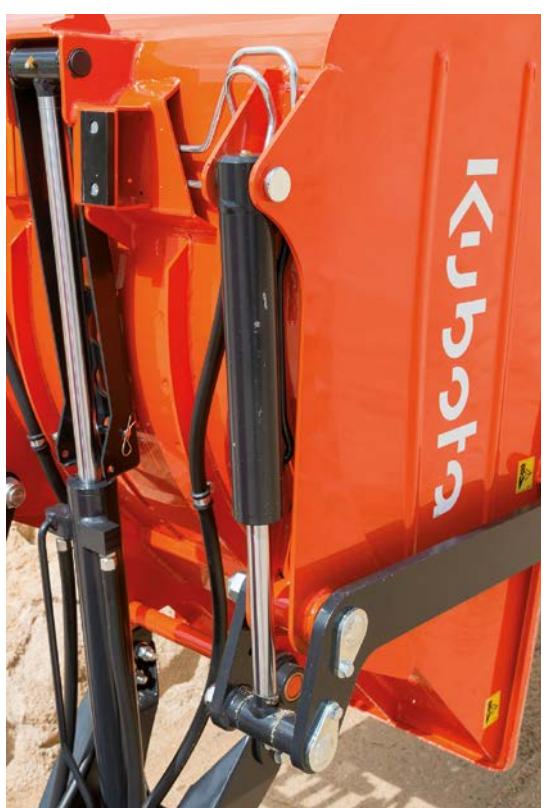
La pelle autochargeuse est actionnée par deux vérins situés sous la benne. Du fait de leur position, ils sont bien protégés et offrent une bonne capacité de levage.
