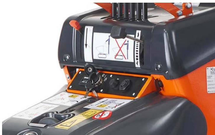
Toutes les versions de moteurs diesel et essence ont un démarrage électrique qui doit être actionné depuis le poste de conduite par la clé de contact. Cela vous garantit un démarrage facile dans toutes les conditions.
