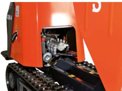
Les transporteurs sur chenilles KC70-4 ont été équipés d'une transmission hydraulique. Cette technologie de pointe offre un contrôle en douceur. L'opérateur peut sélectionner la vitesse la mieux adaptée au terrain, et passer facilement de la grande vitesse (3,3 km/h) pour les surfaces planes, à la petite vitesse (2,2 km/h) pour les surfaces plus accidentées. Cette solution vous permet d'effectuer un travail efficace et productif, réduisant l'entretien et la consommation de carburant.
