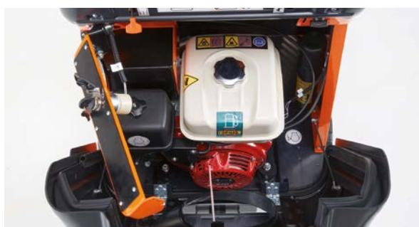
La console de la version essence peut être ouverte pour faciliter le remplissage du réservoir. Dans la version diesel, l'opération est également facile à réaliser.
