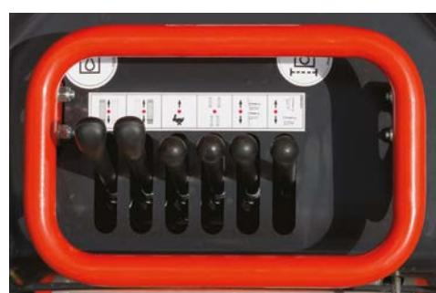
Une barre de maintien protège les leviers de commande. Tous les leviers de commande sont faciles à atteindre et à activer. Les fonctions des machines sont faciles et précises à utiliser.
