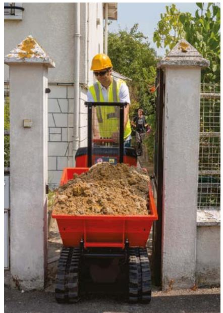
Tout comme les autres versions, les KC70HD/VHD-4 sont particulièrement adaptés aux chantiers dans des espaces réduits. Son châssis variable lui permet de passer par des passages étroits en voie étroite (758 mm) et d'assurer une excellente stabilité en voie large (1058 mm).
