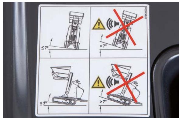
Si la machine est sur une pente supérieure à 8° (sur les deux axes) et que la benne est relevée, une alarme avertit du danger potentiel.
