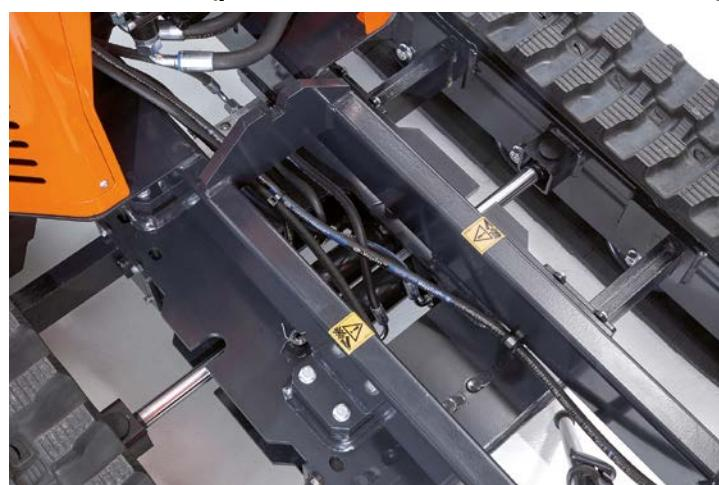
Ce type de structure permet de réduire la largeur de la machine à 758 mm (versions standard) ou d'augmenter la largeur à 1058 mm pour une plus grande stabilité.
