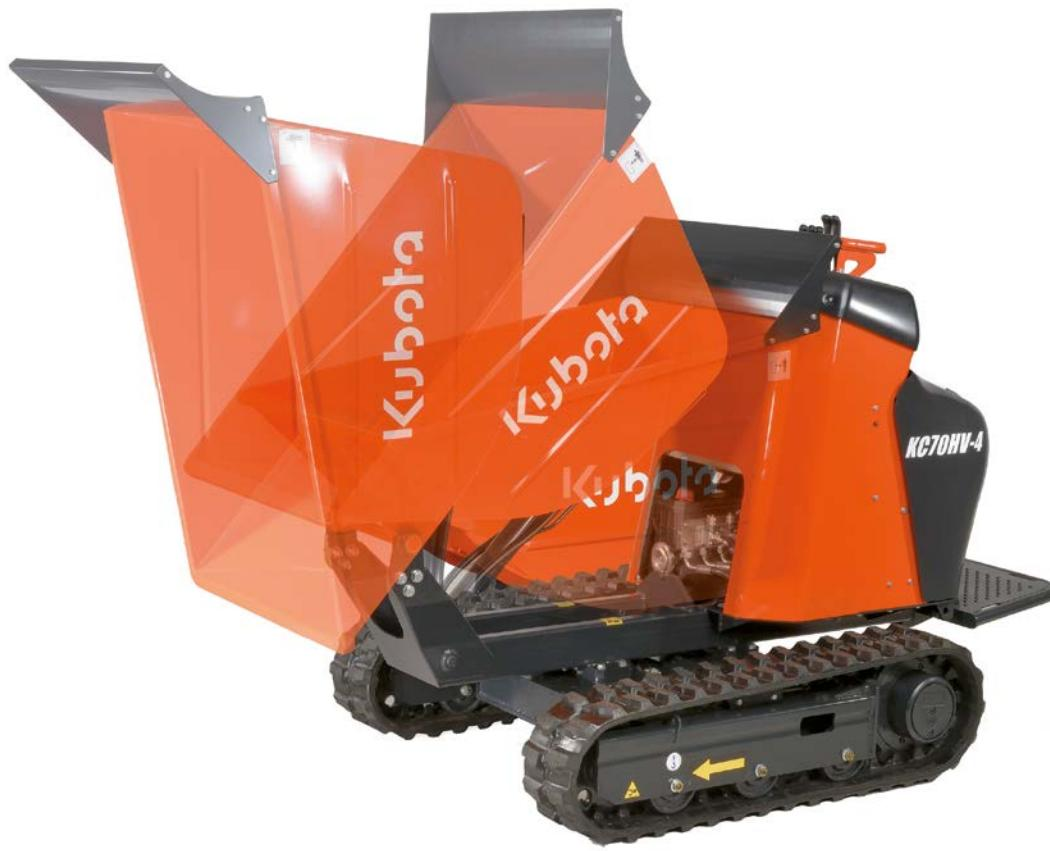
Les opérations de déchargement sont rapides et faciles. La forme de la benne a été conçue pour assurer un déversement rapide des matériaux. Avec un angle de déversement de 88°(85° pour les versions HD/VHD), tous les matériaux glissent facilement de la benne.
