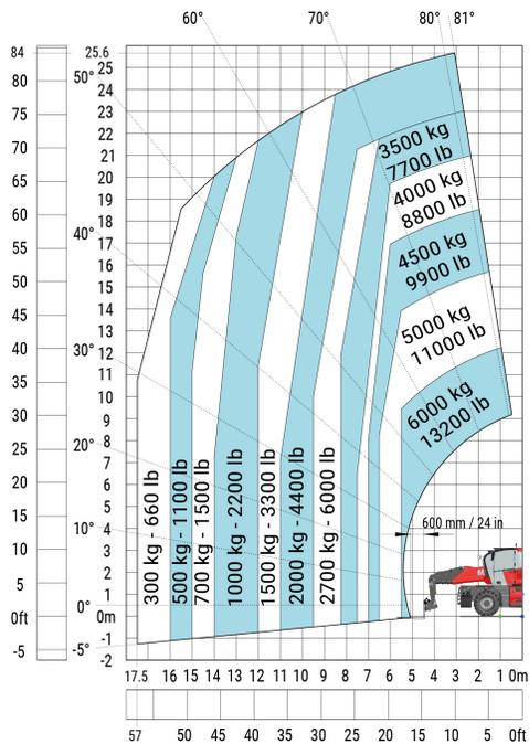
Machine sur stabilisateurs abaissés avec nacelle 1000 kg
