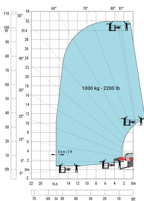
Machine sur stabilisateurs abaissés avec nacelle 365 kg
