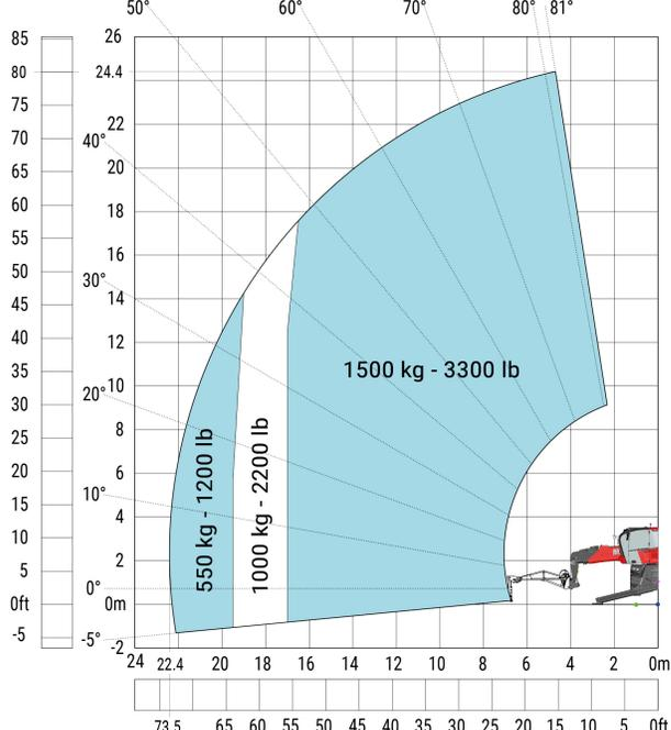
Machine sur stabilisateurs abaissés avec nacelle 365 kg
