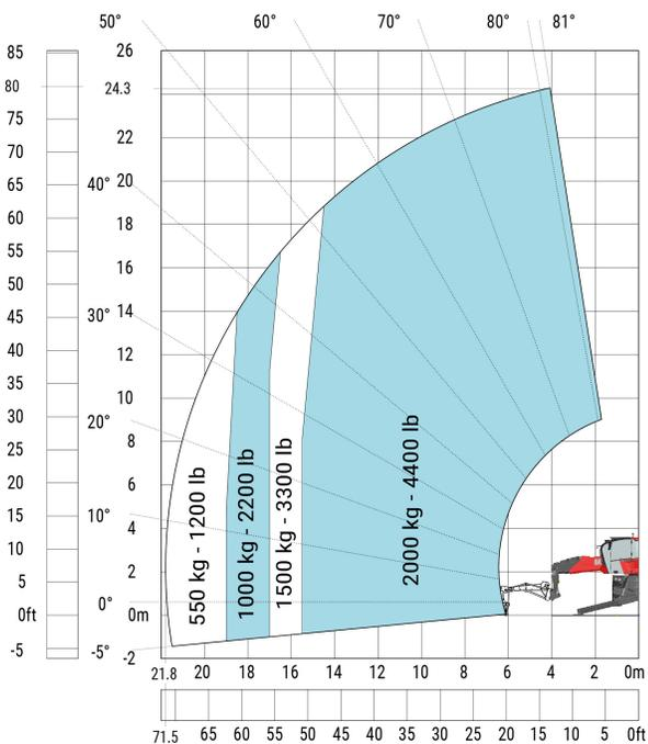
Machine sur stabilisateurs abaissés avec crochet 9000 kg (Métrique)
