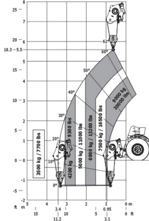
Machine sur stabilisateurs avec pendulaire Métrique
