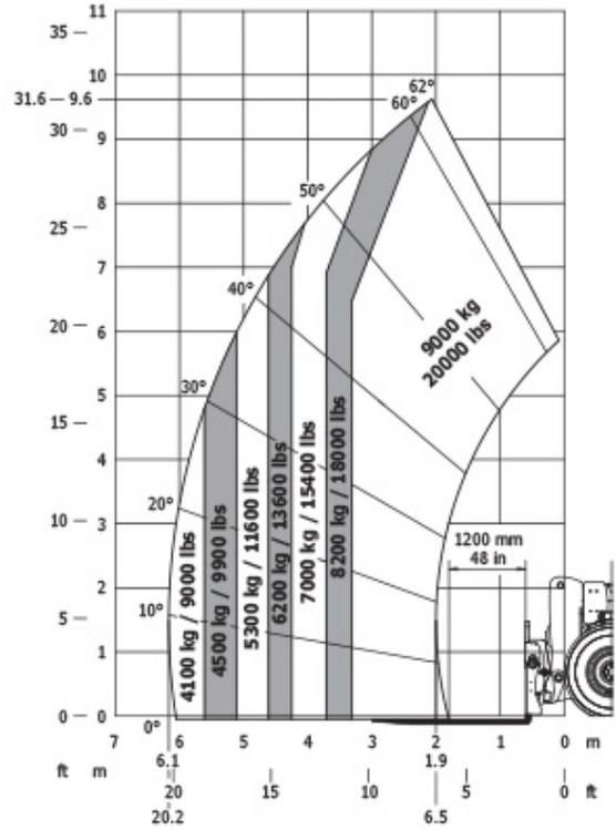
Machine sur pneus avec pendulaire Mètric
