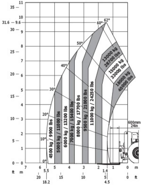
Machine sur pneus avec fourches LC 1200 mm Mètric
